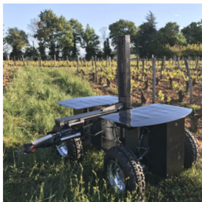
Wall-Ye Myce Vigne (robot de taille, désherbage, épamprage, tonte, binage, ...) 100% autonome
